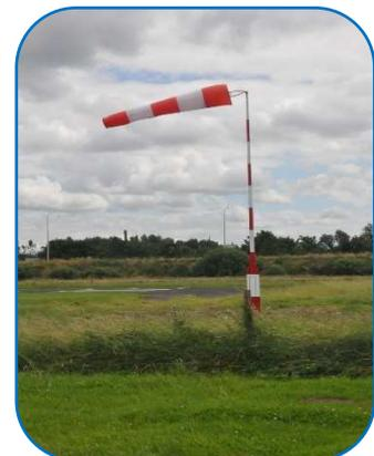
toires. Cela peut être le résultat d'obstructions locales ou de configuration des lieux. L'observation de la manche à air permet une estimation plus ou moins précise du vent dans sa force et sa direction. Généralement formée de bandes rouges et blanches, chaque bande de tissu représente sensiblement 5 kt.
